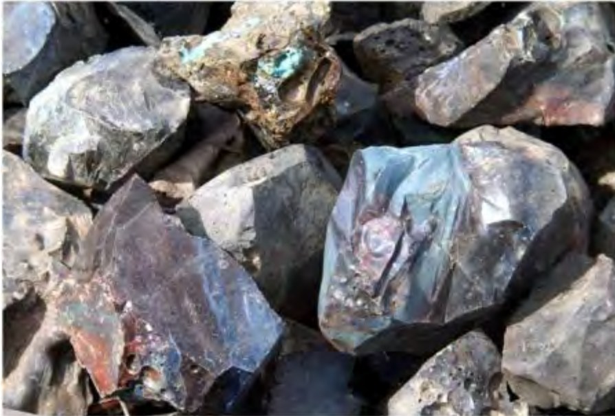
Bild 3: Kupferschlacke der 1495 bis 1505 entstandenen Lutherhalde. Das Bild zeigt deutlich, dass es im frühen 16. Jahrhunderts noch nicht gelang homogene metallarme Schlacken herzustellen. Die Reste dieser Halde zeugen zugleich von der Tätigkeit des Vaters Martin Luthers (Hans Luder) als Hüttenmeister (Foto Stedingk).
