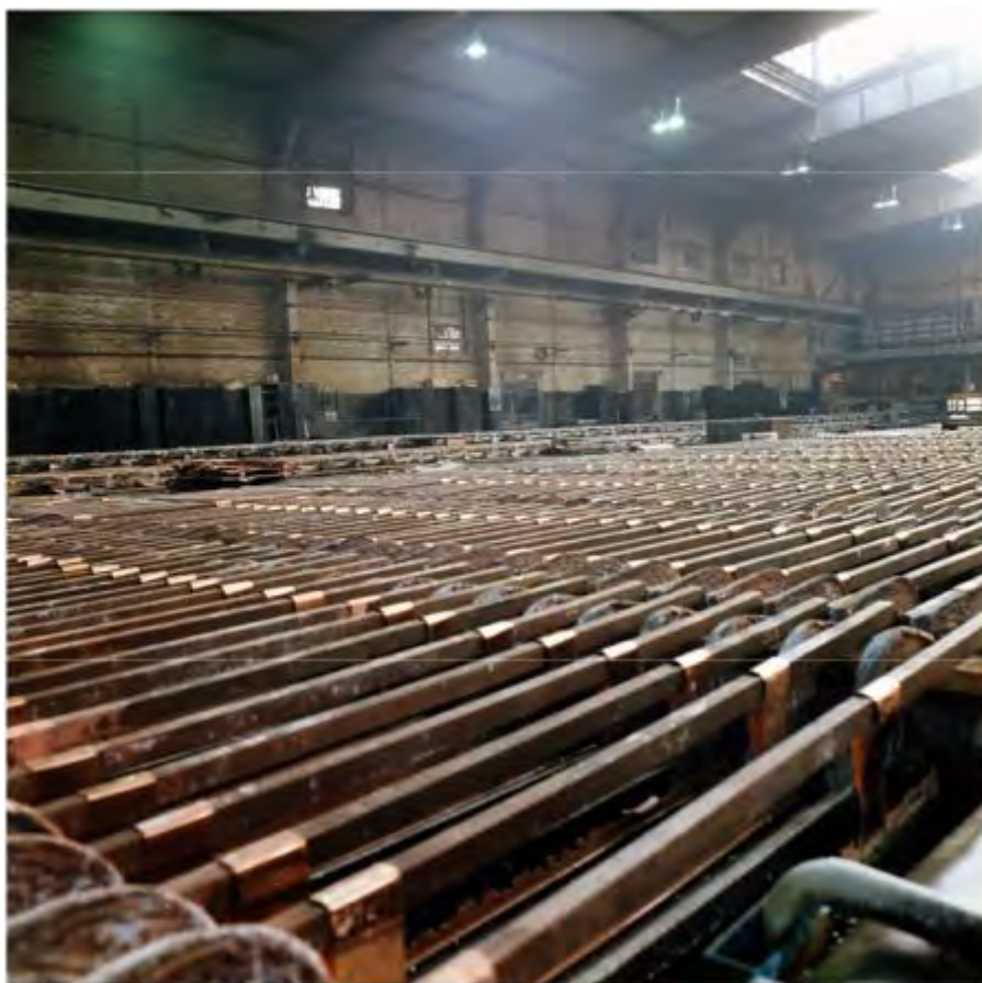
Bild 15: Kupferelektrolyse auf der Kupfer-Silber-Hütte (Gottesbelohnungshütte) bei Hettstedt (Foto Archiv Mansfeld Museum, Hettstedt)
