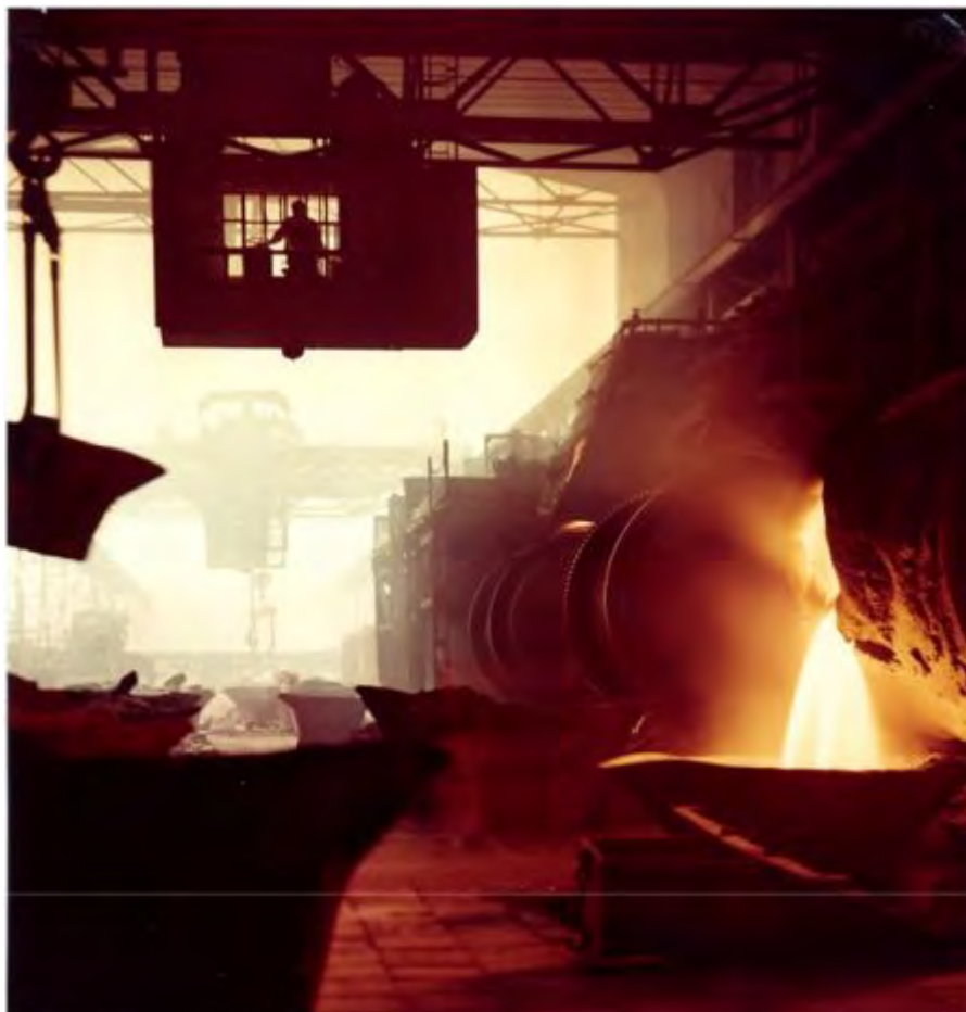
Bild 14: Schlackenabguss des Konverters 5 auf Bessemerie der Kupfer-Silber-Hütte Hettstedt (Foto Archiv Mansfeld Museum, Hettstedt)
