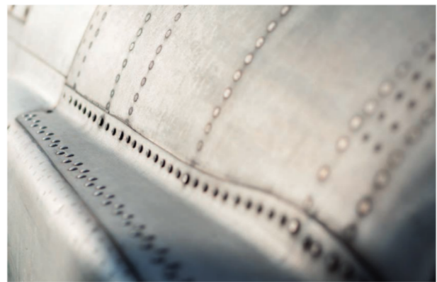
Abb. 9: Vernietete Aluminiumaußenhaut eines Flugzeugs Quelle: © ClipDealer
