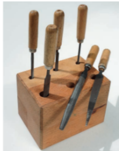
Abb. 56: Werkzeugblock mit verschiedenen Schlüsselfeilen, die für sehr feine Arbeiten verwendet werden
