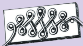
Abb. 65: Faulzer mit Nagelstiften
