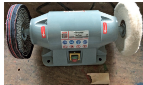
Abb. 58: Poliermaschine mit zwei verschiedenen Schwabbel-scheiben und Polierwachs im Vordergrund
