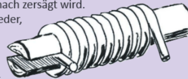
Abb. 64: Faulzer für runde Kettenglieder
