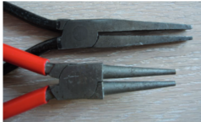
Abb. 59: Flachzange und Rundzange
