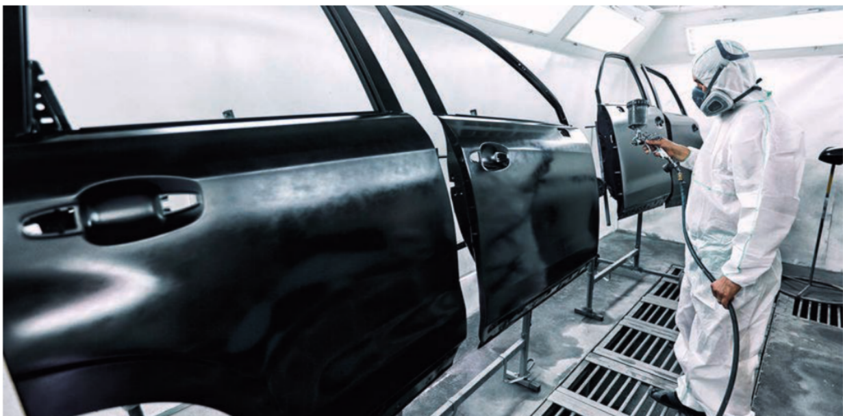
Abb. 78: Autolackierung in staubfreiem Raum
