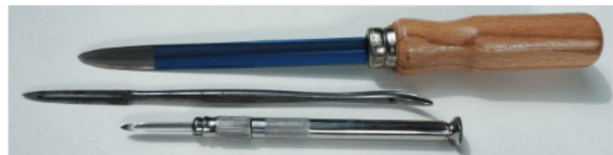
Abb. 57: Verschiedene Dreikantschaber, in der Mitte mit Polierstahl am rechten Ende
