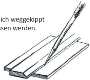
Abb. 29: Anreißen entlang einer Stahlschiene
