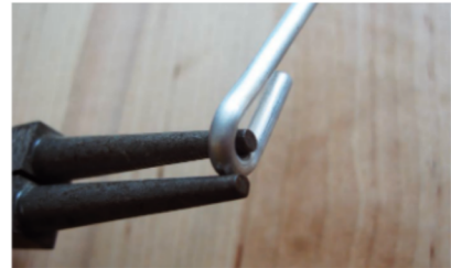
Abb. 61: Biegen kleiner Radien
