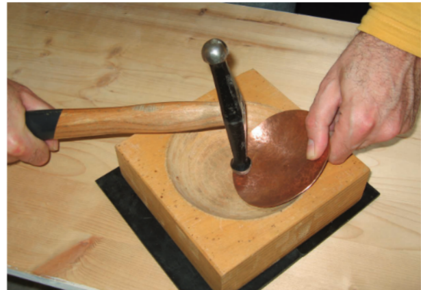
Abb. 76: Treiben einer Kupferrolle in einer Treibmulde
