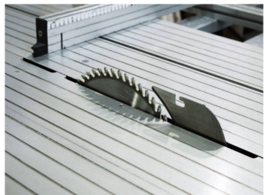
Abb. 12: Formatkreissäge mit Tisch und Queranschlag aus Aluminium Quelle: © ClipDealer
