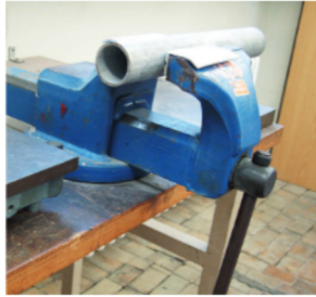
Abb. 35: Parallelschraubstock mit Schutzbacken
