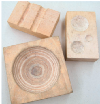
Abb. 71: Treibmulden aus Holz
